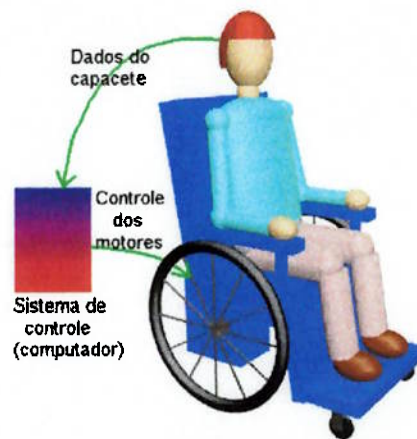
Figura 6.1 Esquema funcional do sistema de controle da cadeira de rodas
